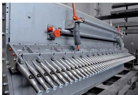
En los últimos años, **BASALAN** ha realizado la reforma de diversas cajas de entrada existentes mediante la instalación de un distribuidor central y control de perfil por dilución. De la misma forma, ofrecemos a nuestros clientes la posibilidad de cortar cualquier caja de entrada hidráulica con el fin de dejarla a la medida deseada.
