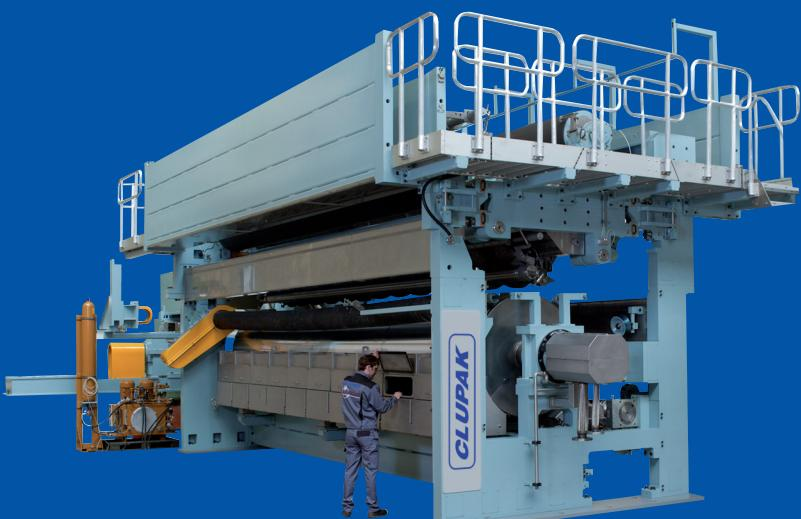
La **Unidad Extensible Clupak** se emplea en las máquinas de papel –principalmente de embalaje, bolsas y sacos– para controlar la absorción de energía de tensión, conseguir un alargamiento longitudinal del papel hasta un 15%, y para eliminar roturas en el producto terminado.
